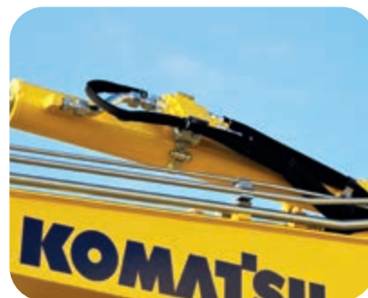
Válvulas de ruptura da mangueira no cilindros da lança e do braço
