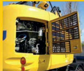
Os principais pontos de manutenção podem ser facilmente acedidos ao nível do solo
