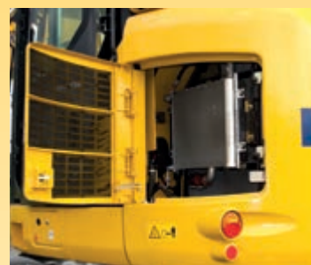
As grelhas do radiador estão integradas nas portas laterais para uma fácil limpeza a partir do nível do solo
